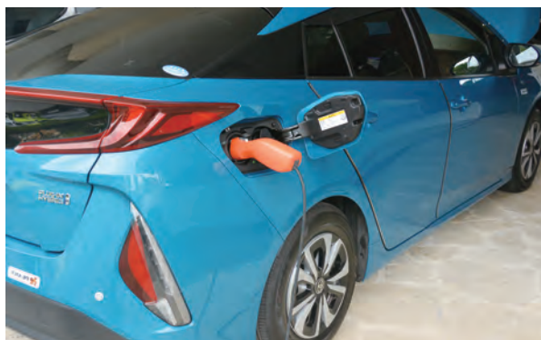
Fig.4 プリウス PHV は普通充電コンセントからヴィークル パワーコネクター ® を介して給電 (車内給電プラグコンセントも装備されている)
