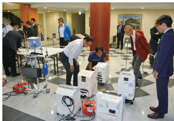
Fig.9 HQT ステーションを想定した酸素濃縮器の配置、駐車 場の各 PHV・EV からの給電は 30m ドラム式延長コードで館 内へ、さらに 3 口 20m 延長コードを介して機器に接続
