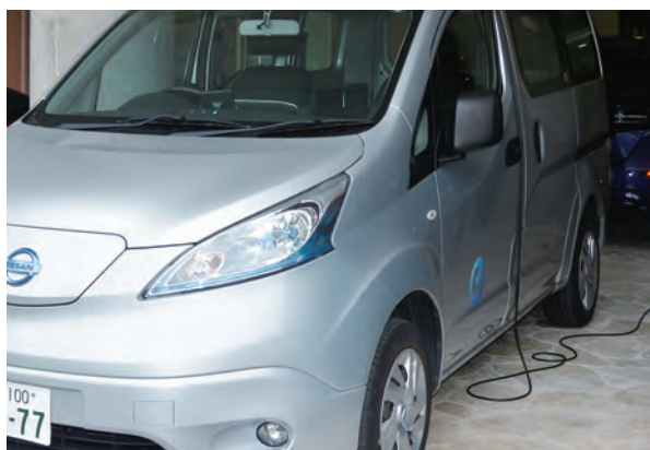
Fig.7 e-NV200 は室内給電プラグコンセントから給電
