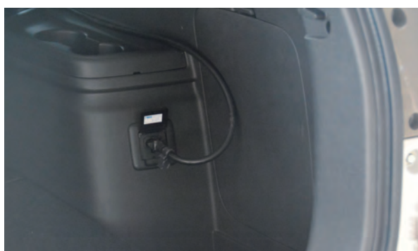
Fig.5 アウトランダー PHEV は室内給電プラグコンセント から給電
