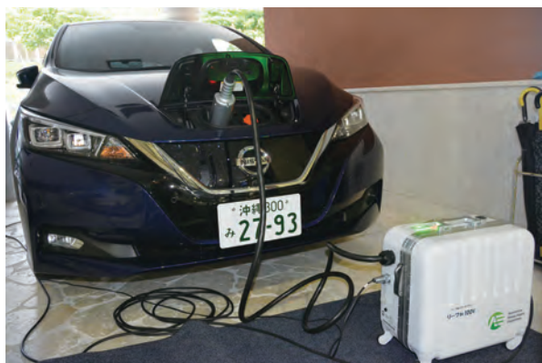
Fig.6 リーフは急速充電ポートからリーフ to100V ® を介して 給電
