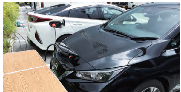
Fig.10 那覇市避福祉難所訓練 HOT ステーションの電源に使用した PHV・EV
